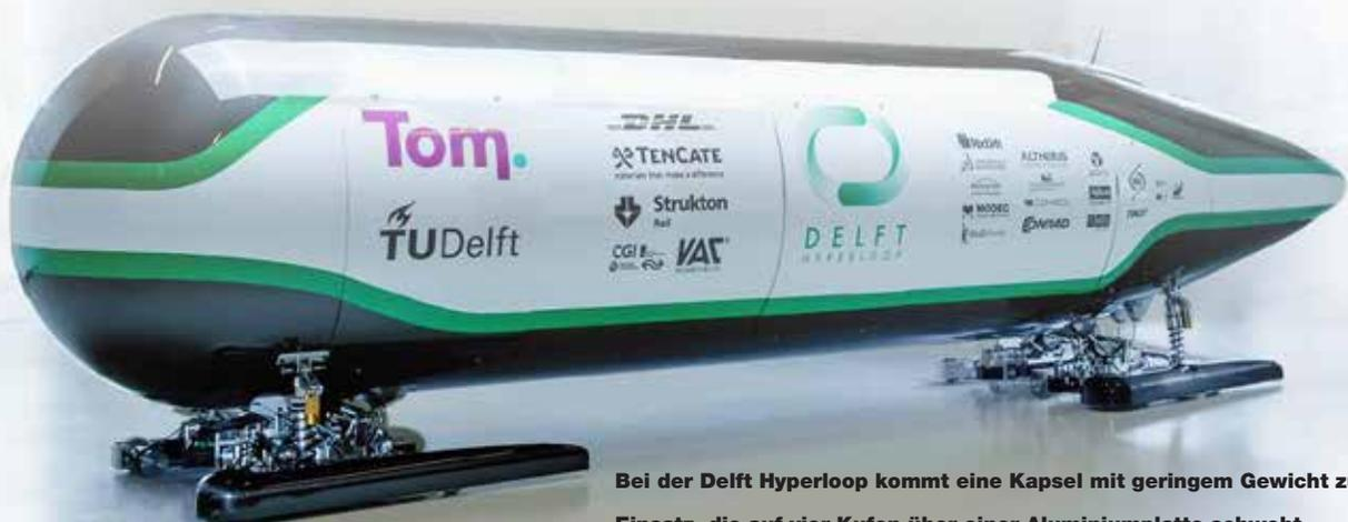
Bei der Delft Hyperloop kommt eine Kapsel mit geringem Gewicht zum Einsatz, die auf vier Kufen über einer Aluminiumplatte schwebt.
