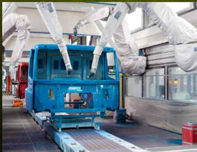
**Foto rechts: Das neue Transportsystem ist ebenfalls eine bedeutende Innovation. Mit ihm können die Fahrerhäuser in den Bädern gedreht werden.**
