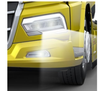
LED-LEUCHTEN MIT KURVENLICHT & NEBELLEUCHE
