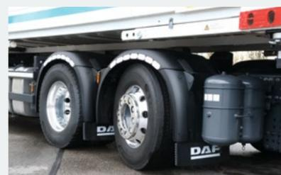
Die gelenkte Nachlaufachse wird laut DAF im BDF-Bereich stetig beliebter
