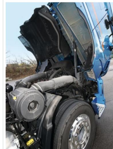
Aufwendige Geräuschdämmung des Motors
