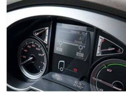
Die Achslasten und Reifenluftdrücke lassen sich dank CAN-Verbindung auch vom Anhänger im Display anzeigen
