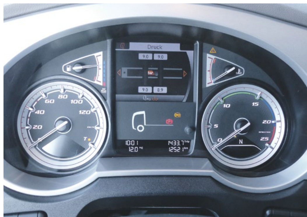
Am Anhänger sind nicht nur die Achslasten abrufbar, sondern auch Reifendrücke.
