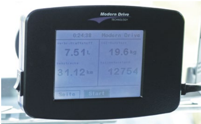
Mit unserem Modern Drive Messcomputer lesen wir Verbrauchsdaten auf zwei Kommastellen genau aus und zeichnen die gesamte Fahrt auf. Anschluss einfach über die OBD II Buchse.
